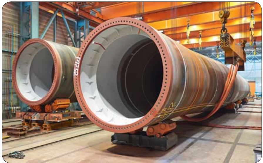
Die Monopiles werden aus Einzelsegmenten zusammenschweißt und anschließend beschichtet.
