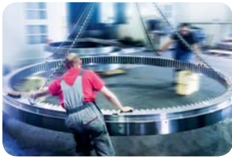
Für einen Braunkohle-Absetzer wurde eine Doppel-Axial-Kugeldrehverbindung mit vier Metern Durchmesser benötigt.
